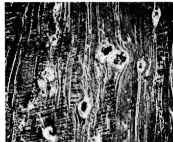
Fig. 12 - Écroissage des grains ferritiques au voisinage de la surface de frappe.
