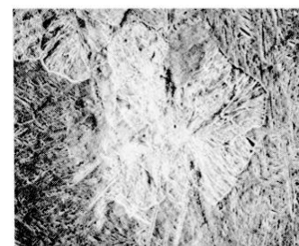
Fig. 8 - Perlite nodulaire et bainite.
