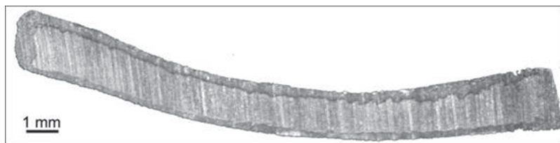
Fig. 3. Coupe métallographique de l'échantillon 1029 isolat 01 (La Rochelle), enrichissement de surface.
