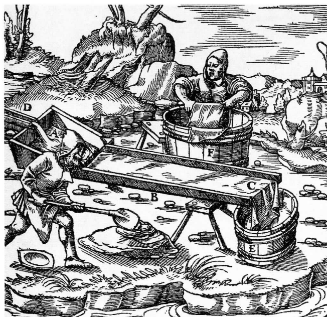
Fig. 13. Lavage au sluice au XVI e siècle. G. Agricola (1556): De Re Metallica.
