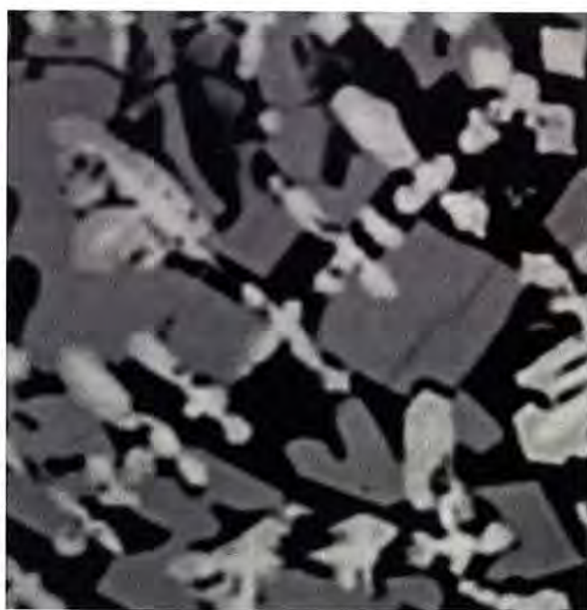
Fig. 16. Hercynite (clair). Ech. MON 67. Image en électrons rétro-diffusés (BSE).
