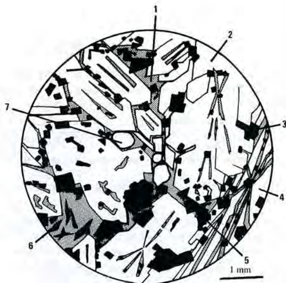
Fig. 154. SGD: scorie grise dense coulée plaque épaisse. Ech. MON 6. Texture microscopique dans la partie centrale.
